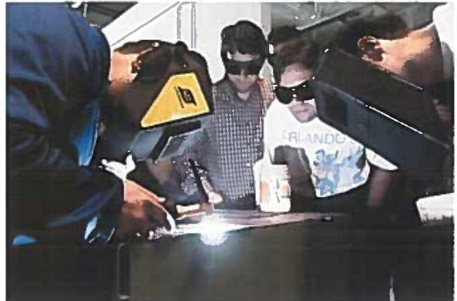
6.22-01 Trabajos de soldadura con el equipo de seguridad adecuado
