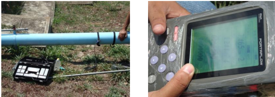
Figura n° 1. Equipo de medición de caudal
